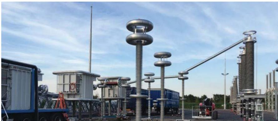
Abbildung 10. Anordnung für die Resonanzprüfung eines Kabelsystems
