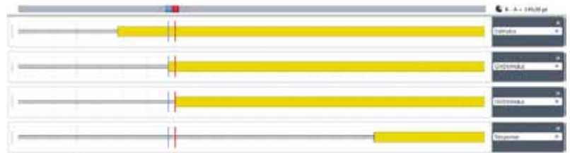
Abbildung 2: Von oben nach unten: Binäreingangsänderung und GOOSE in Anlage 1, GOOSE und Binärausgangsänderung in Anlage 2
