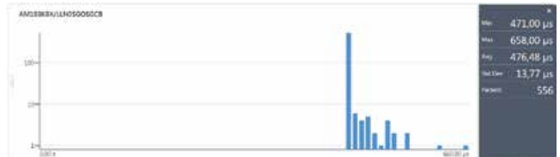
Abbildung 3: Histogramm der Laufzeit im (längeren) redundanten Pfad
