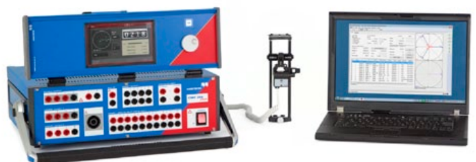
Ensemble de test CMC avec tête de lecture optique. Fonctionnement via un CMControl ou un PC sous un environnement Windows
