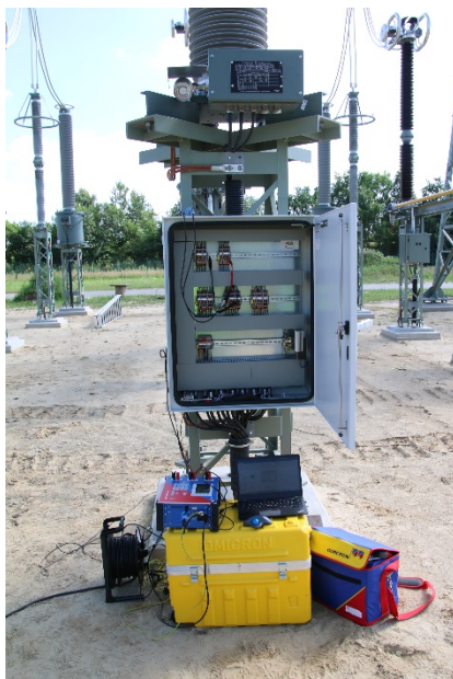
Abb. 5: Messaufbau des CT Analyzers im Feld
