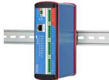
ISIO 200 montiert auf DIN-Hutschiene
