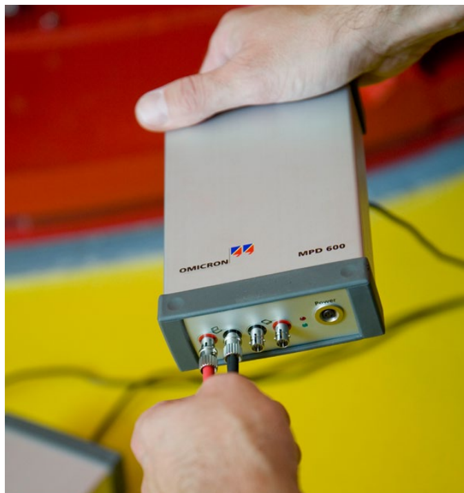
MPD 600 – Modulares „Plug-and-Play“-System
