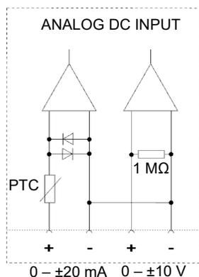
**Nota:** Si se sobrepasan los valores de entrada especificados, las entradas de medida pueden dañarse.
