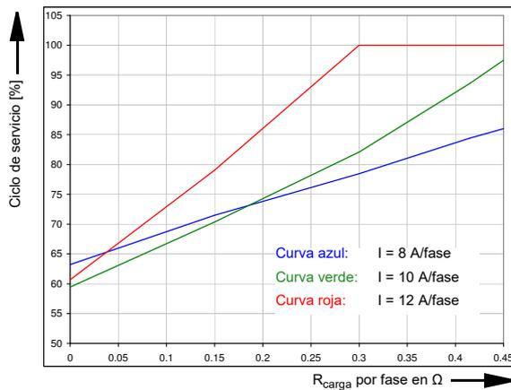
En una configuración 6 × 12,5 A a T<sub>ambiente</sub> = 50 °C
