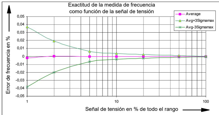
**Condiciones:** velocidad de muestreo 9,48 kHz,  $f_{in} = 20 \text{ Hz} \dots 1 \text{ kHz}$ .
