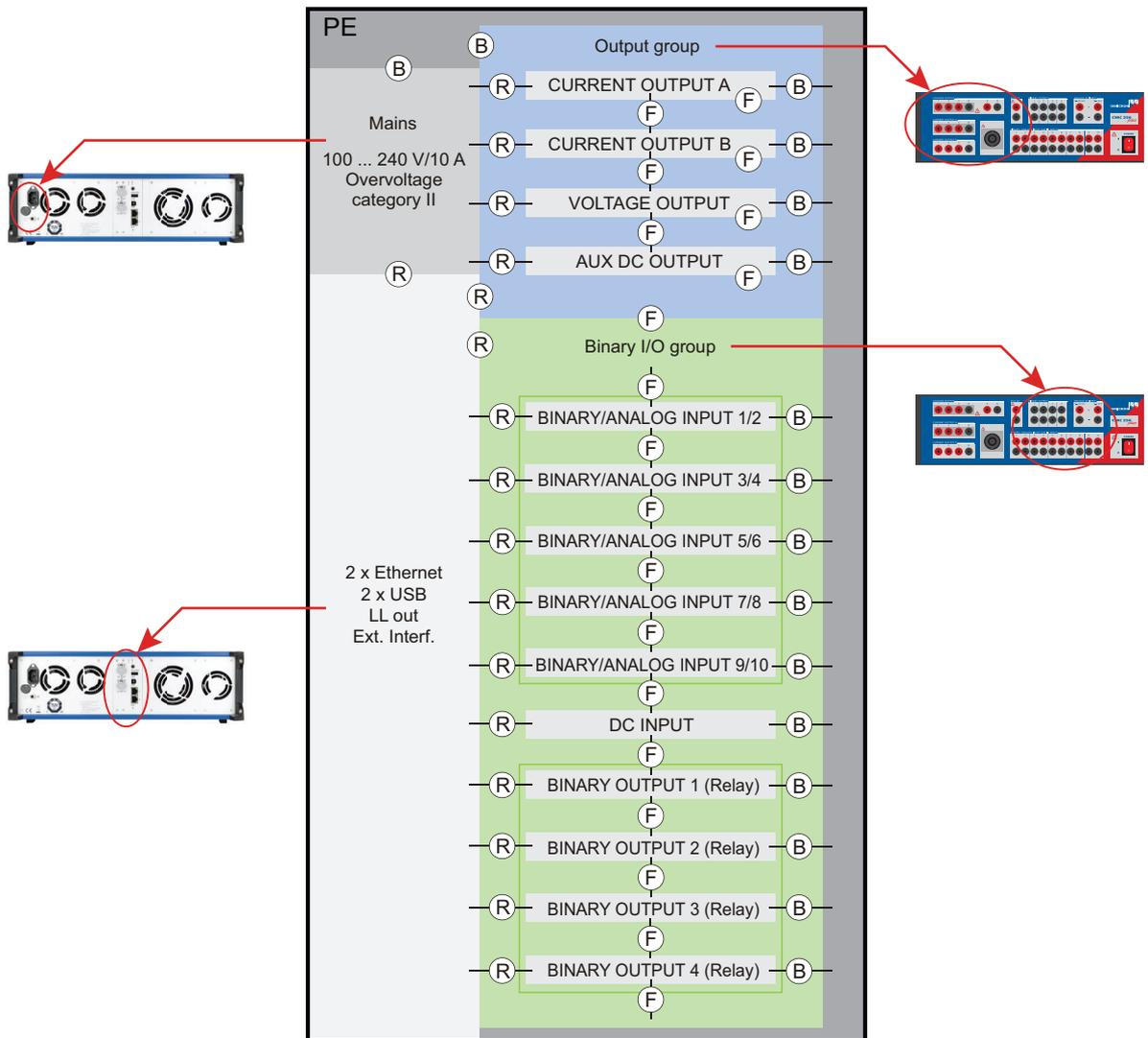
Aislamiento diseñado para el grado de contaminación 2.
