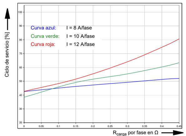
En una configuración 6 × 12,5 A a T<sub>ambiente</sub> = 25 °C
