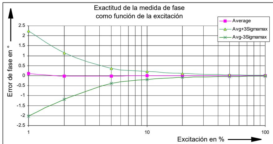
**Condiciones:** velocidad de muestreo 9,48 kHz,  $f_{in} = 50$  Hz.
