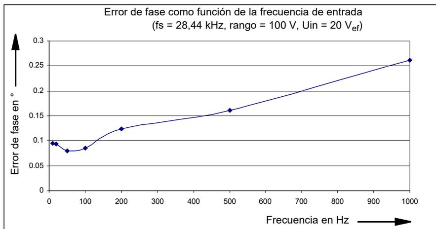
**Condiciones:** tiempo de integración 1 s, señal de medida sinusoidal, velocidad de muestreo = 28,44 kHz, rango de medida 100 V, excitación en ambos canales 20  $V_{ef}$ .
