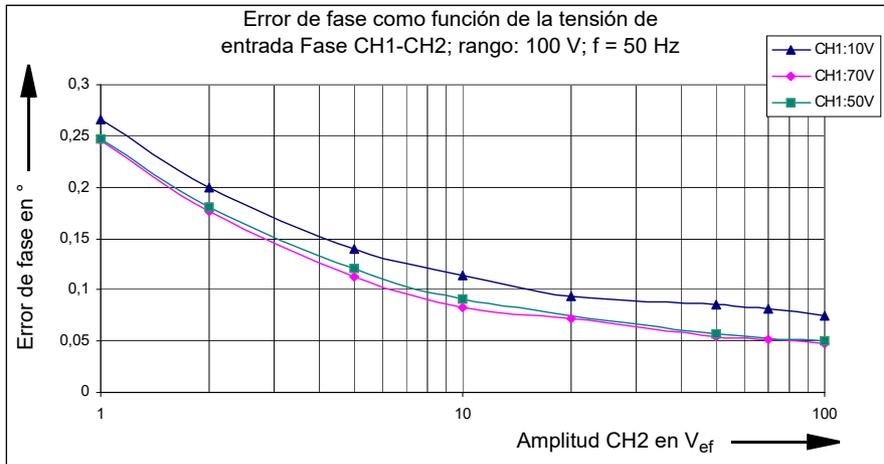
**Condiciones:** tiempo de integración 1 s, señal de medida sinusoidal, rango de medida 100 V, f = 50 Hz, velocidad de muestreo 28,44 kHz.
