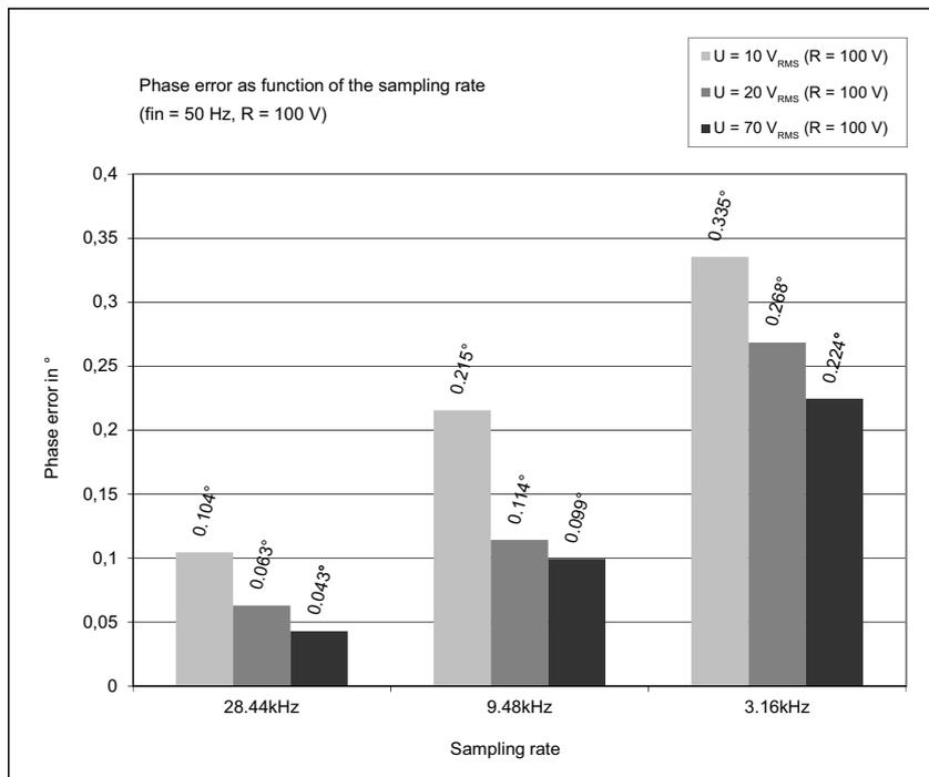
**Condiciones:** tiempo de integración 1 s, señal de medida sinusoidal, f = 50 Hz, rango de medida 100 V, idéntica excitación en ambos canales (20 V, 70 V).
