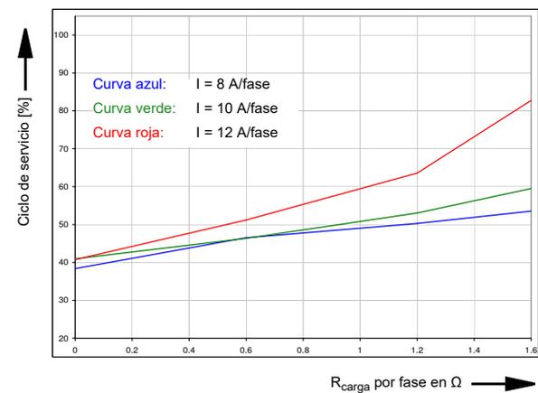
En una configuración  $3 \times 12,5 A$  a  $T_{ambiente} = 25 \text{ }^\circ\text{C}$
