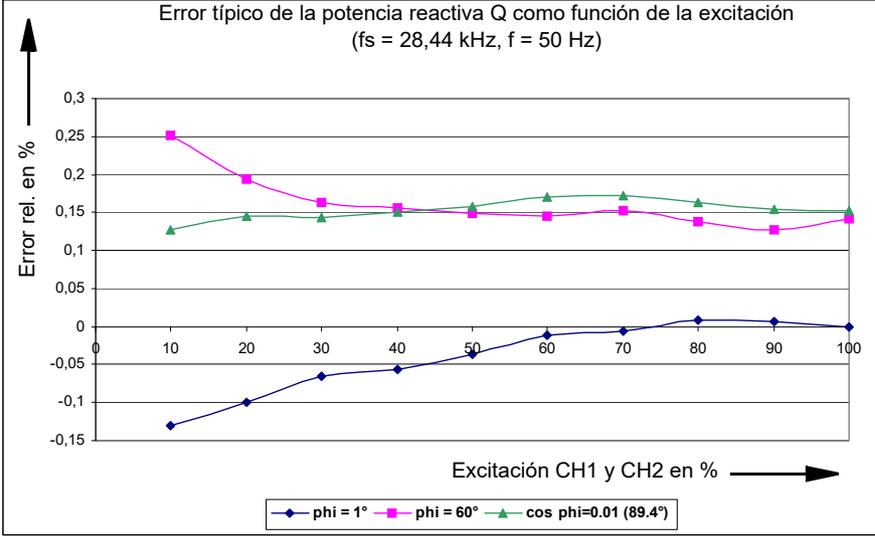
Condiciones: tiempo de integración 1s, señal de medida sinusoidal, velocidad de muestreo = 28,44 kHz,  $f_{in} = 50$  Hz.
