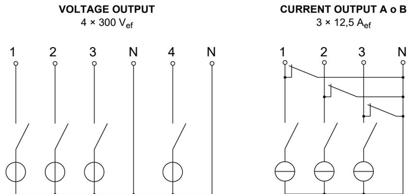
Todos los generadores de tensión y corriente pueden configurarse independientemente con respecto a la amplitud, ángulo de fase y frecuencia.
