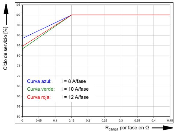
En una configuración  $3 \times 12,5 A$  a  $T_{ambiente} = 50 \text{ }^\circ\text{C}$
