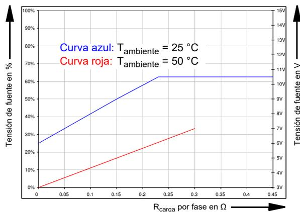
A una temperatura de  $50 \text{ }^\circ\text{C}$ , la tensión de fuente no puede reducirse lo suficiente para garantizar el funcionamiento continuo para cargas con una resistencia superior a  $0,3 \Omega$  por fase.
