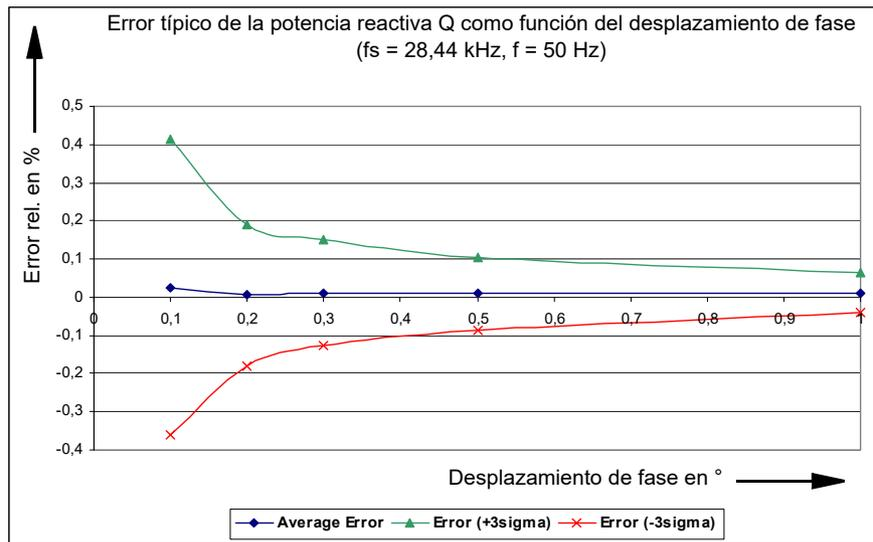
**Condiciones:** tiempo de integración 1 s, señal de medida sinusoidal, velocidad de muestreo = 28,44 kHz, ambos canales con la misma excitación 70 %.
