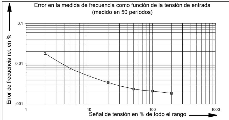
**Condiciones:** tiempo de integración 1 s, señal de medida sinusoidal.
