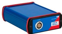
Das CMLIB REF6xx ist ein Schnittstellenadapter für den Anschluss von ABB Relion-Schutzrelais mit Sensoreingängen (z. B. REF615 oder REX640) an die Kleinsignalausgänge eines CMC-Prüfgeräts. Zur Simulation von Rogowski-Sensoren wandelt CMLIB REF6xx die Signale der Kleinsignalausgänge des CMC in differenzielle (symmetrische) Signale um. Zusätzlich liefert der Adapter auch das für die Prüfung benötigte Spannungssystem.
