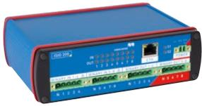
Das ISIO 200 erweitert CMC-Prüfgeräte um acht Binäreingänge und acht Binärausgänge, die jeweils in zwei Potenzialgruppen angeordnet sind. Es kommuniziert mit Hilfe von IEC-61850-GOOSE-Meldungen und wird über die integrierte Web-Bedienoberfläche konfiguriert.
