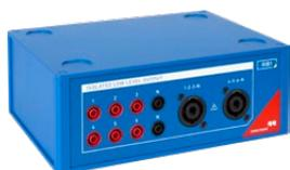
RIB1 dient zur elektrischen Trennung der von den CMC-Prüfgeräten ausgehenden SELV-Kleinsignale. Die Box wird zwischen die Kleinsignalausgänge des Prüfgeräts und das zu prüfende Gerät geschaltet und bietet eine verstärkte Isolation für die Kleinsignalausgänge des Prüfgeräts.
