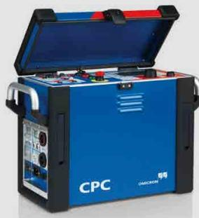
Das CPC 100 ist unser multifunktionales Prüfgerät für Primäreinspeisung, das für zahlreiche elektrische Prüfungen an Leistungstransformatoren, Messwandlern, rotierenden Maschinen, Erdungssystemen, Übertragungsleitungen, Kabeln und Leistungsschaltern eingesetzt werden kann.
