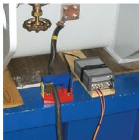
Beispiel für eine HFCT-Erdungsleitung an einem Leistungstransformator
