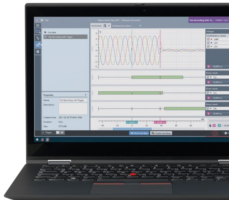
Medição de tempo de abertura/fechamento de um disjuntor com EnerLyzer
