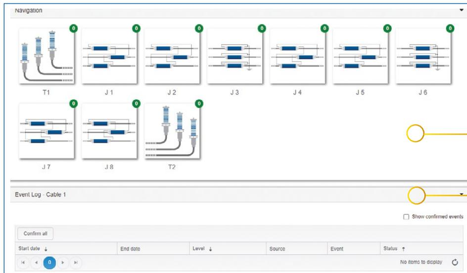
Визуализация состояния всей наблюдаемой кабельной арматуры в режиме реального времени
