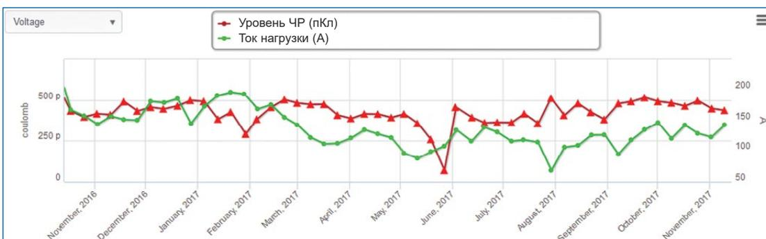
ПО обеспечивает корреляцию множественных наблюдаемых параметров в одном графике.
