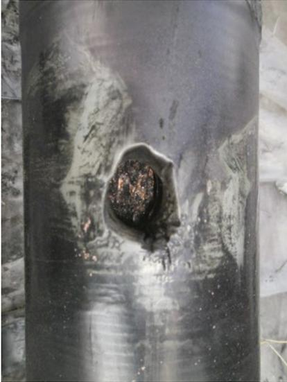
Пробой изоляции концевой муфты кабеля
