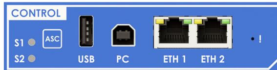
Figure 2-1: Ports de communication de l'ARCO 400
