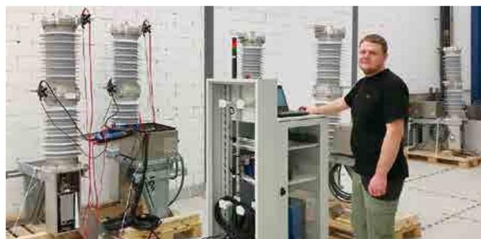
Carro de pruebas de CIBANO 500 en la línea de producción de ABB para interruptores de potencia de vacío de media tensión.
