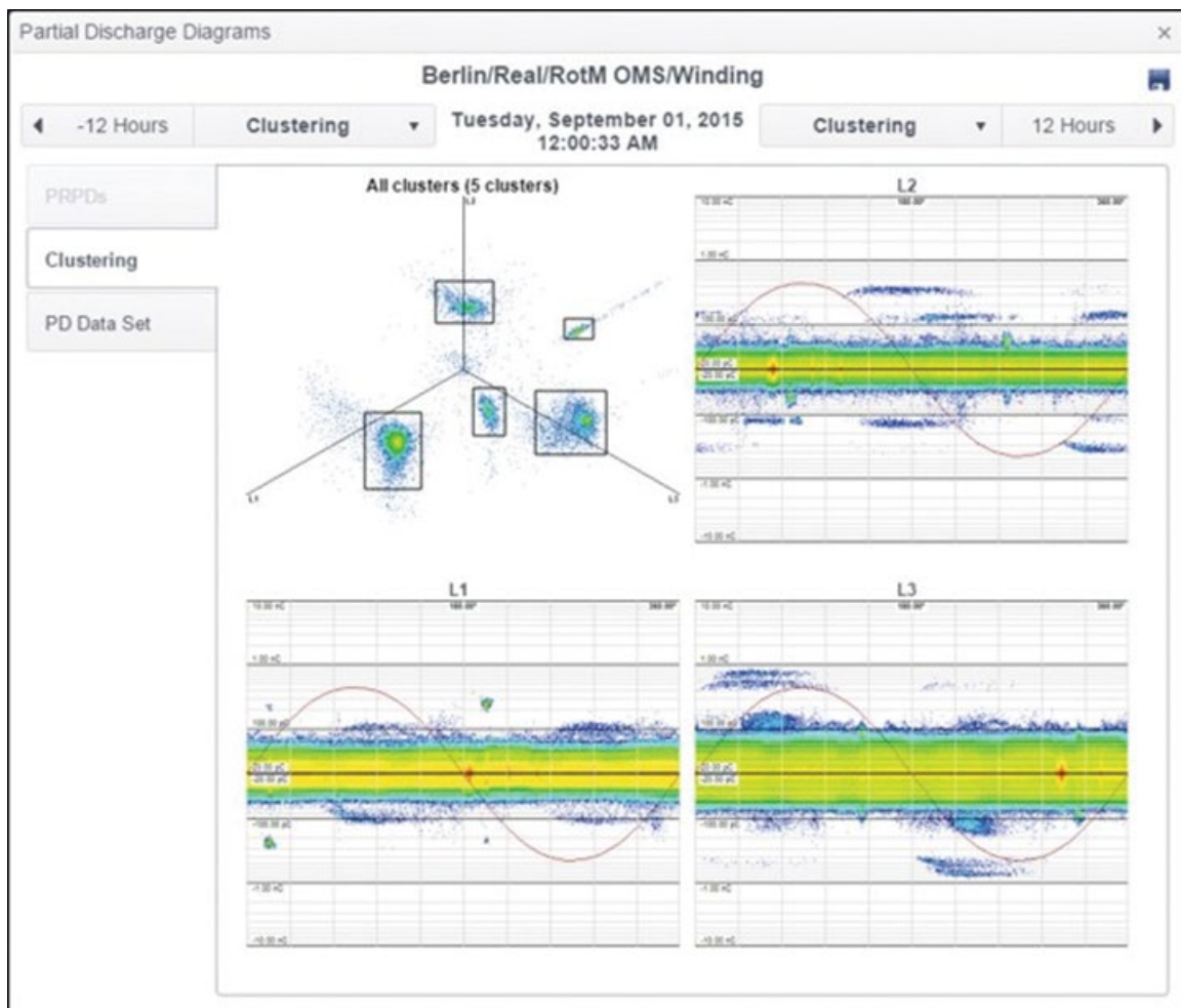
Abbildung 2: Automatisierte Cluster-Separierung. In dieser Ansicht werden das PRPD-Diagramm und das zugehörige 3PARD-Diagramm dargestellt. Die Rechtecke um die Cluster werden automatisch identifiziert.
