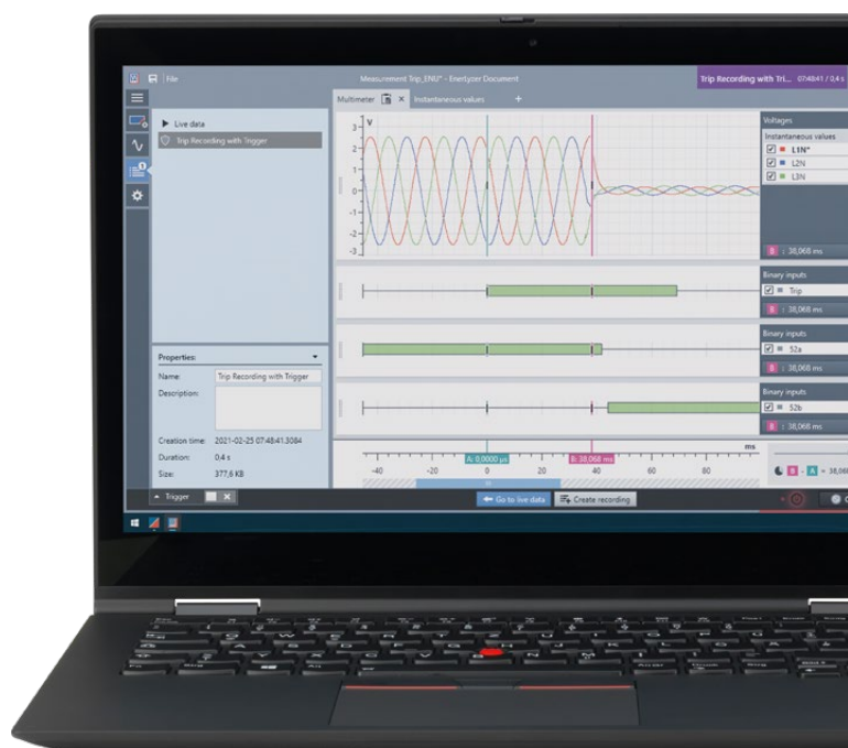
Medición del tiempo de apertura/cierre de un interruptor de potencia con EnerLyzer
