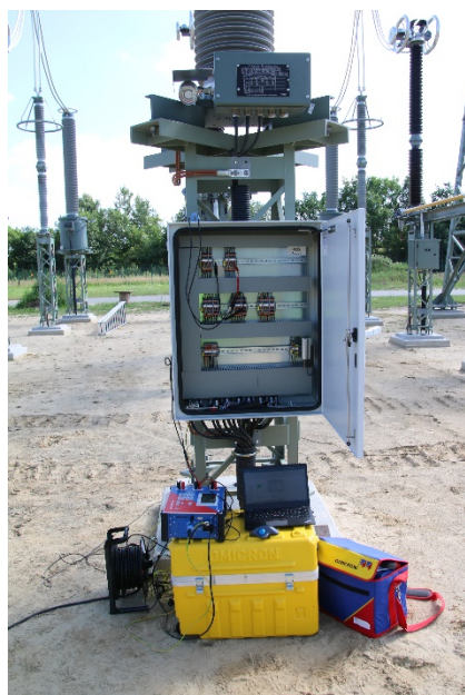
图 5：现场测量 CT analyzer 配置
