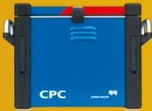
Tragbares Prüfgerät für die Primär- und Sekundäreinspeisung und einfache Schutzprüfungen.
