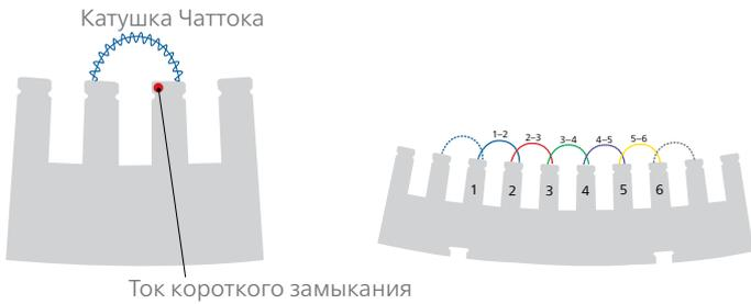
Обнаружение тока короткого замыкания путем измерения потока рассеяния с помощью датчика. В ходе различных измерений разные пазы сканируются последовательно. Шаг катушки соответствует величине зубцов между пазами, что обеспечивает определенную область перекрытия.
