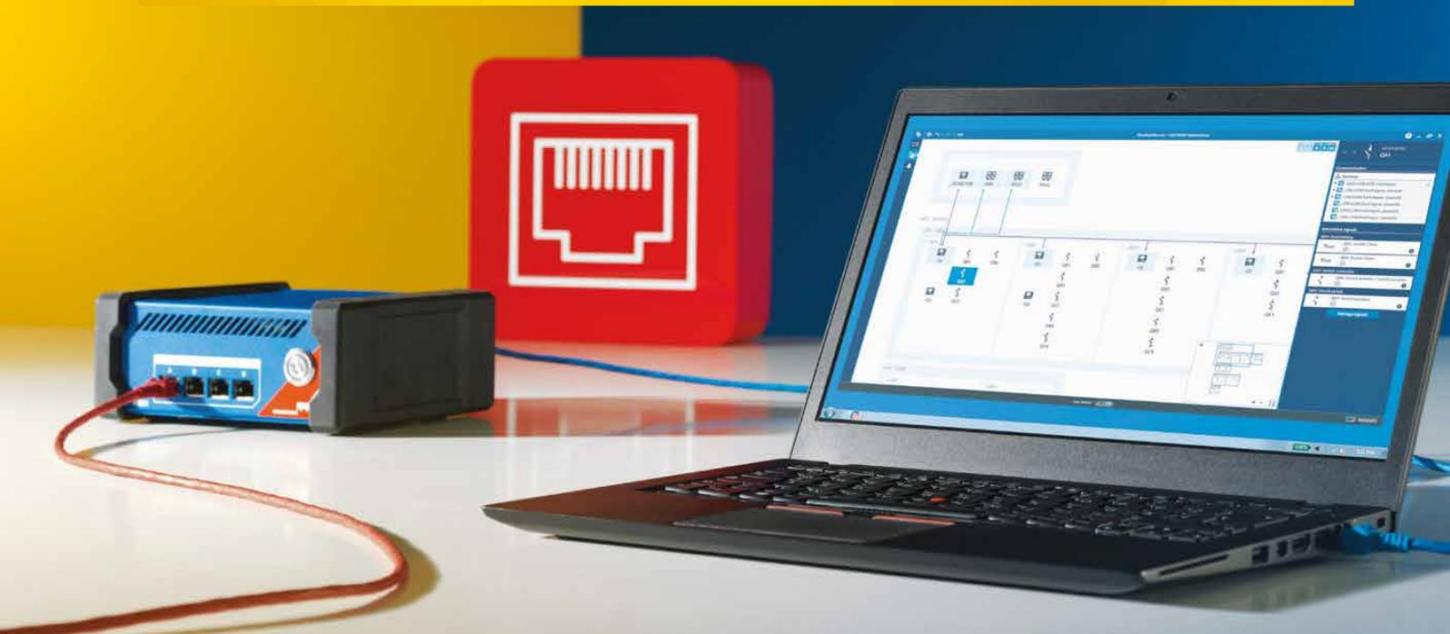
Le système d'automatismes de poste (SAS) CEI 61850 est devenu un élément essentiel des postes. En tant que composant d'une infrastructure critique, ce système nécessite des actions correctives et mises à jour de sécurité constantes. Des tests doivent ensuite être effectués afin de s'assurer que tous les équipements et le système lui-même fonctionnent toujours comme prévu.
