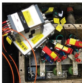
Ejemplo de uso de un HFCT en una caja de conexión cruzada
