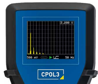
Modo espectro (FFT) para detectar señales acopladas
