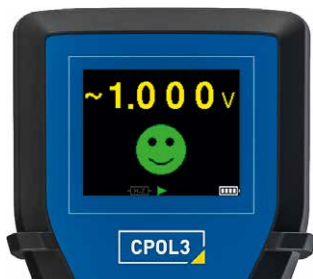
Indicación de polaridad correcta de la señal de prueba
