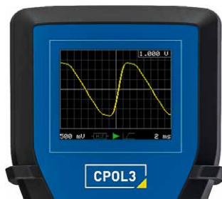
Modo «osciloscopio» para visualizar la forma de onda de la señal
