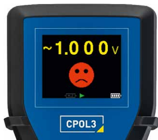
Indicación de polaridad incorrecta de la señal de prueba
