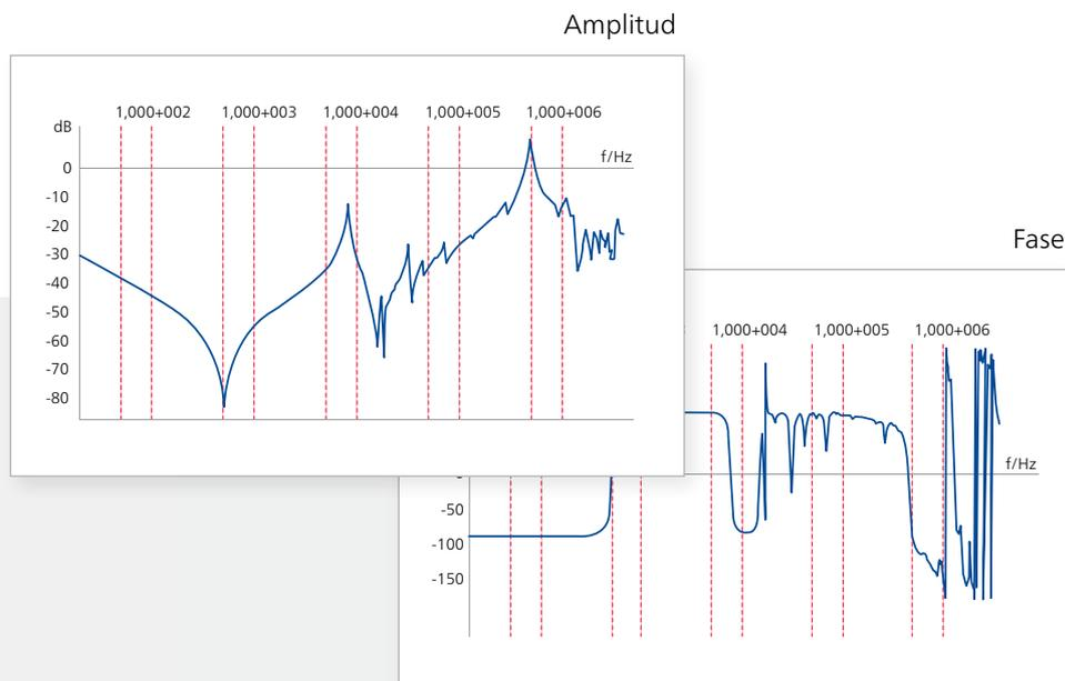
Los cambios geométricos dentro y entre los elementos de la red producen desviaciones de la respuesta en frecuencia del transformador. FRANEO 800 compara los resultados de las mediciones con la huella digital original.
