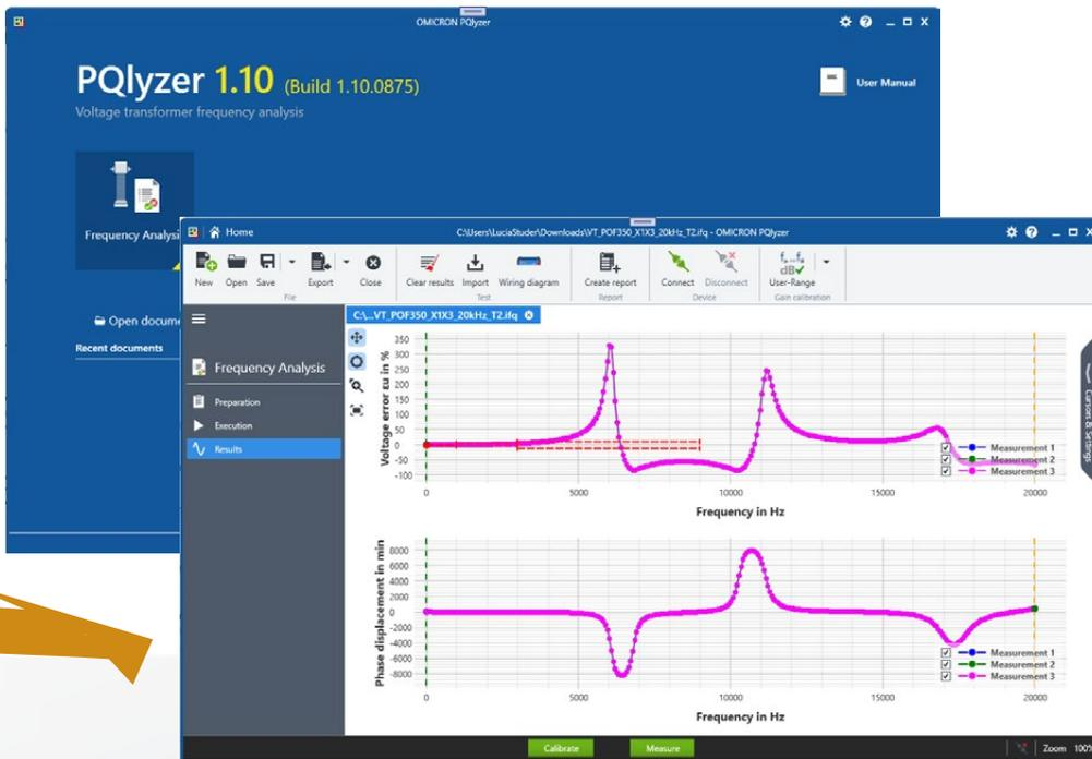
El software PQlyzer ayuda de la mejor manera a medir las características de transferencia de los transformadores de medida utilizando ajustes de barrido configurables, diagramas de cableado y elaboración de informes para facilitar su uso.
