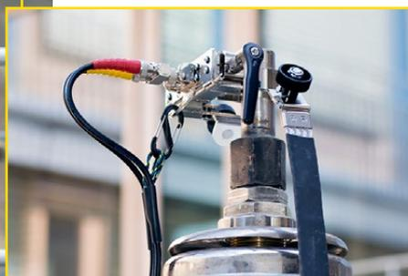
Debido al diseño especial de las pinzas de las bornas se consigue un contacto confiable.
