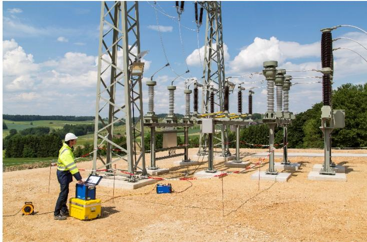
Das umfassende Prüfgerät CPC 100 kann für unterschiedliche elektrische Standardprüfungen an zahlreichen Anlagenbetriebsmitteln eingesetzt werden.
