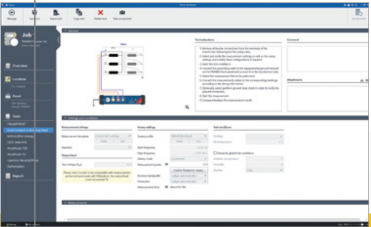
PTM 通过显示接线图提示，并依据国际标准的测试诊断确认变压器状态，来提供最好的技术支持。
