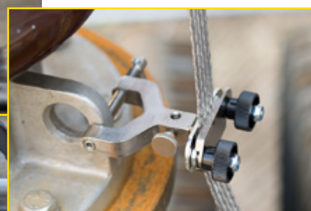
带尖刺的法兰螺丝夹钳可以保证金属性的可靠接触，即便是表面有油漆或者污垢。
