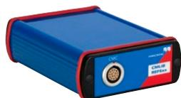
O CMLIB REF6xx é um adaptador de interface para conexão de relés de proteção ABB Relion equipados com entradas de sensores (por exemplo, REF615 ou REX640) às saídas de sinal de baixo nível de equipamentos de teste CMC. Para a simulação do sensor Rogowski, o CMLIB REF6xx converte os sinais de saída de baixo nível do CMC em sinais diferenciais (equilibrados). Além disso, o adaptador também fornece o sistema de tensão simulada.
