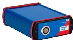
O CMLIB 7Sx8 é um adaptador de interface para conexão de relés de proteção Siemens Siprotec 4 Compact equipados com entradas de sensores (por exemplo, Siprotec 7SJ81) às saídas de sinal de baixo nível de equipamentos de teste CMC. O CMLIB 7Sx8 converte os sinais de saída de baixo nível do CMC em sinais diferenciais (equilibrados). Além disso, o adaptador também fornece o sistema de tensão simulada.
