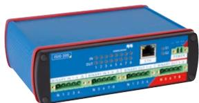
O ISIO 200 é usado para ampliar equipamentos de teste CMC com oito entradas binárias e oito saídas binárias, em dois grupos potenciais. Ele se comunica usando mensagens IEC 61850 GOOSE e é configurado pela interface Web integrada.
