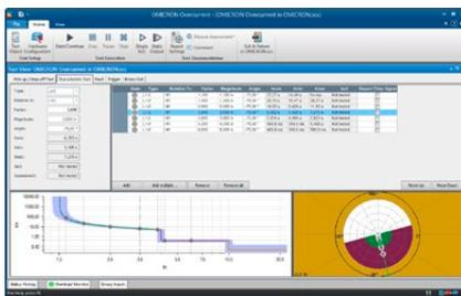
O software sobrepõe as características de cada uma das funções ajustadas, tanto no diagrama I/t quanto no diagrama direcional. Isso inclui todos os elementos que correspondem ao tipo de falta aplicada. Para cada ponto de teste, é feita uma avaliação do desempenho do relé com base nas tolerâncias admissíveis para a medição de corrente e do tempo de operação.
