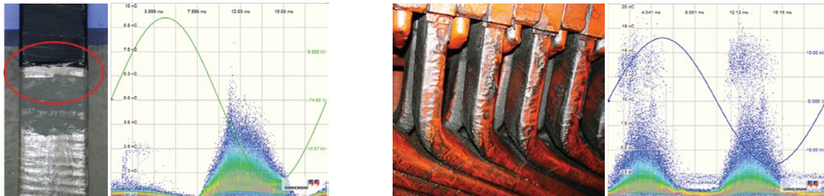
Figure 3 : Problèmes potentiels sur le système d'isolation d'une machine tournante avec le diagramme PRPD corrélé. La cause de gauche représente une extrémité de la répartition des potentiels déconnectée de la protection extérieure contre l'effet couronne. Celle de droite représente une zone d'extrémité d'enroulement polluée et les décharges de surface et entre phases qui en résultent.
