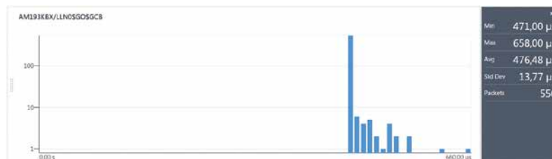
Figura 3: Histograma del retardo de propagación en trayectoria redundante (más larga)
