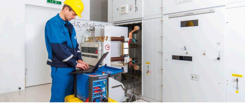
времени отключения с текущими результатами, полученными с помощью испытательной установки CIBANO 500.
