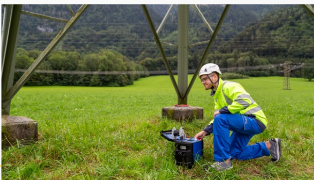
Medición de la georresistividad
