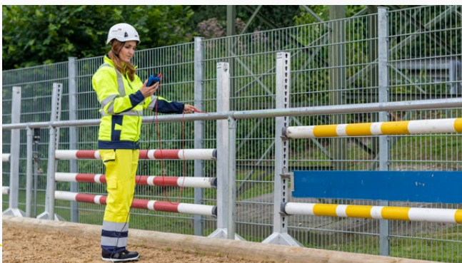
Medición de las tensiones de paso y de contacto con el medidor de mano HGT1
