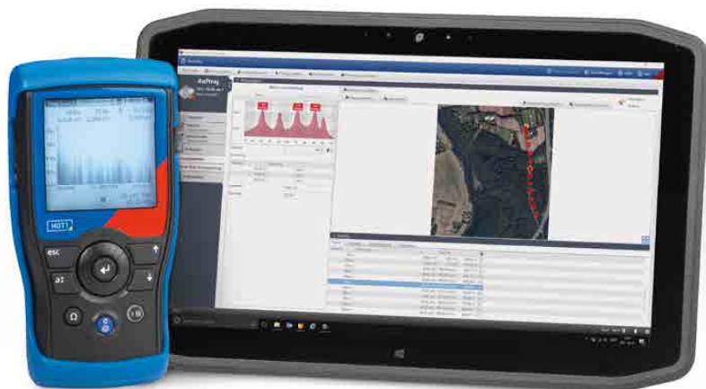
HGT1 mit Tablet: Im Primary Test Manager™ werden die Messergebnisse protokolliert und mit GPS-Koordinaten konkreten Messpunkten zugeordnet.
