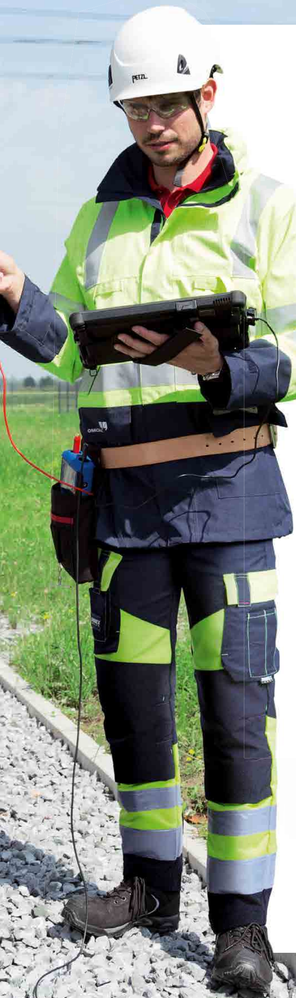
HGT1 mit Tablet: Im Primary Test Manager™ werden die Messergebnisse protokolliert und mit GPS-Koordinaten konkreten Messpunkten zugeordnet.
