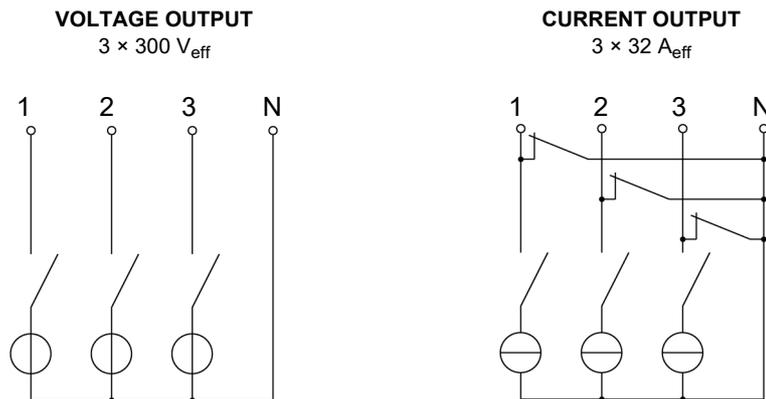
Alle Spannungs- und Stromgeneratoren sind unabhängig voneinander in Amplitude, Phase und Frequenz einstellbar.
