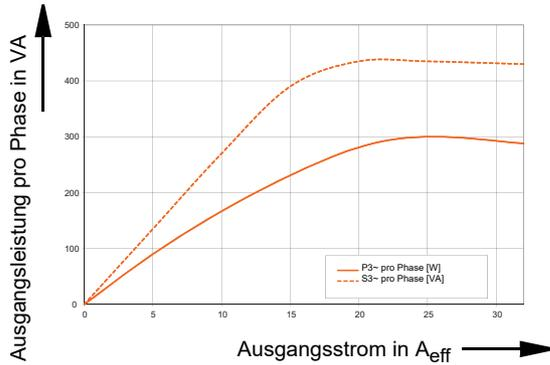
Garantierte Ausgangsleistung pro Phase einer Gruppe (Wirkleistungen in W sind garantierte Werte, Scheinleistungen in VA sind typische Werte)
