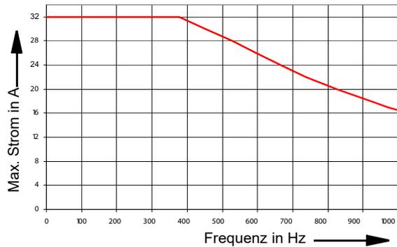
Strom-Derating bei hohen Frequenzen für sinusförmige Signale
