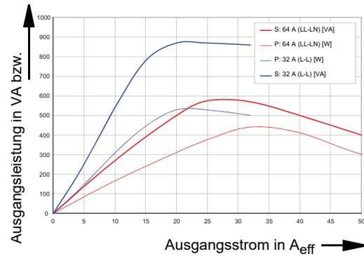
Garantierte Verläufe der Ausgangsleistungen, einphasig (Wirkleistungen in W sind garantierte Werte, Scheinleistungen in VA sind typische Werte)
