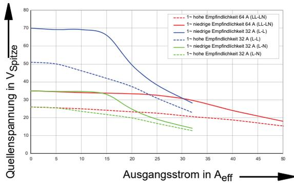
Typische Quellenspannung (50/60 Hz)
