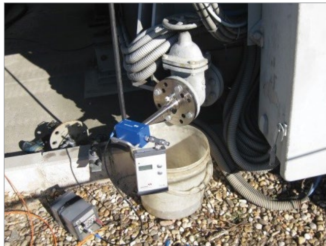
Sensor de la válvula de drenaje para la inserción temporal en el transformador para la medición de DP en UHF
