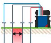
La résistivité du sol est réalisée avant la construction d'un réseau de terre. À partir de ces résultats de test, le réseau de terre est conçu pour répondre à tous les critères nécessaires. Ce test est également appelé méthode des 4 sondes.
