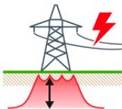
Ce module d'application permet de mesurer l'impédance entre le réseau de terre et la terre de référence. Ce type de mesure est également appelé augmentation du potentiel de terre, chute de potentiel ou méthode des 3 sondes.
