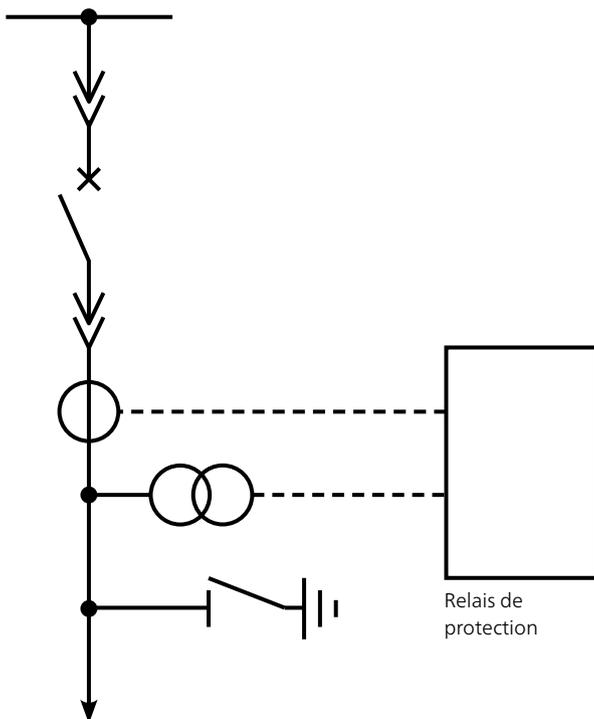
Pour des courants de déclenchement inférieurs à 110 A, il est possible de tester la chaîne complète depuis le primaire du transformateur de courant jusqu'aux contacts des disjoncteurs.
