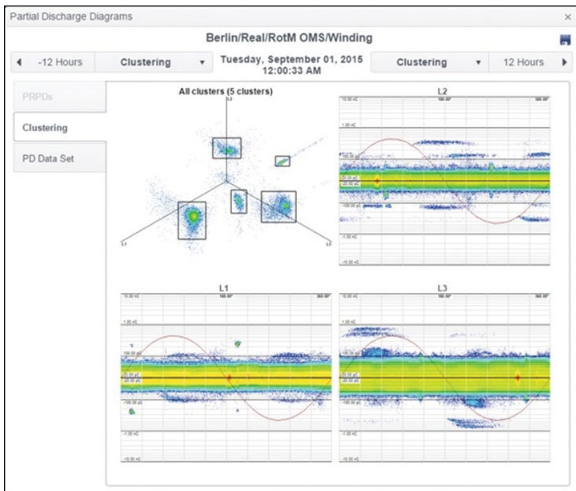
Рис. 2: Автоматизированное разделение кластеров. Здесь показана диаграмма PRPD и соответствующая диаграмма ЗРАД. Прямоугольники вокруг кластеров определяются автоматически.
