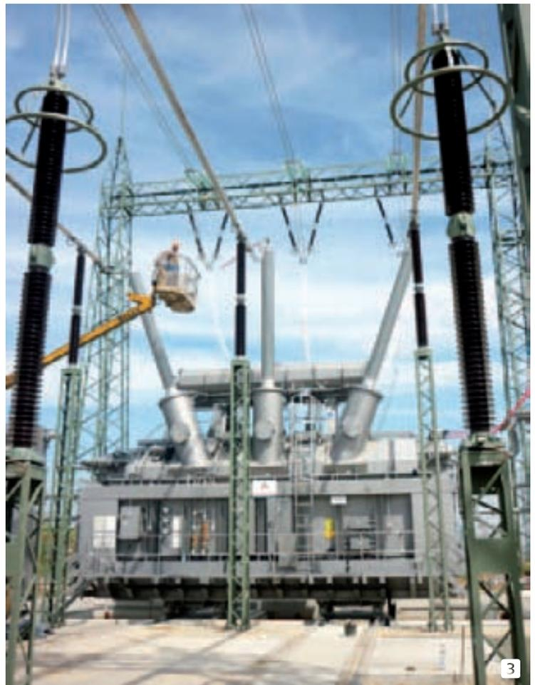
**Messgenau:** **1** Primärprüfgerät zur Generierung von bis zu 2.000 A mit Anschlussleitungen für die Primäreinspeisung. **2** Stromwandlertest mit dem CT Analyzer an einem Durchführungswandler einer 30 kV-E-Drossel. **3** Stromwandlertest mit dem CT Analyzer an einem oberspannungsseitigen Durchführungswandler eines 380 kV-Transformators.
