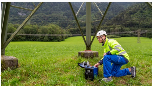
Messung des spezifischen Erdwiderstands
