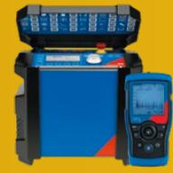
Tragbares akkubetriebenes Prüfgerät für die Primär- und Sekundäreinspeisung und einfache Schutzprüfungen mit Unterstützung für Erdimpedanz-, Erdwiderstands- und Durchgangsmessungen
