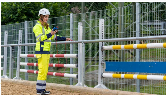
Messung von Schritt- und Berührungsspannung mit dem Handmessgerät HGT1
