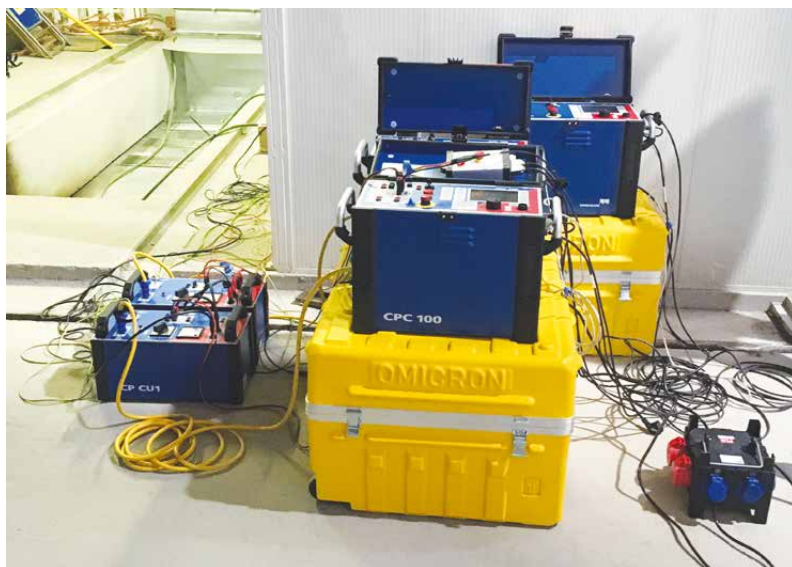
Tres unidades CPC 100 con CPC Sync y tres transformadores de adaptación se utilizan para la excitación de los transformadores tipo seco.
