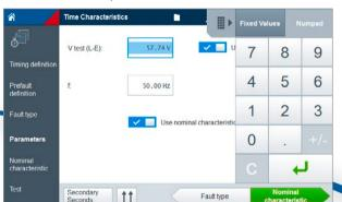
Einfache Eingabe der Prüfparameter über den Ziffernblock. Zudem ist es möglich, häufig verwendete Werte abzuspeichern und wieder aufzurufen.
