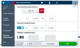
Festlegen der Nennkenlinie des Relais welche als Referenz dient. Es stehen sowohl abhängige (AMZ-)als auch unabhängige (UMZ-) Kennlinien zur Verfügung. (Verfügbar für Fehlertypen I L-E, I L-L und I 3Ph).
