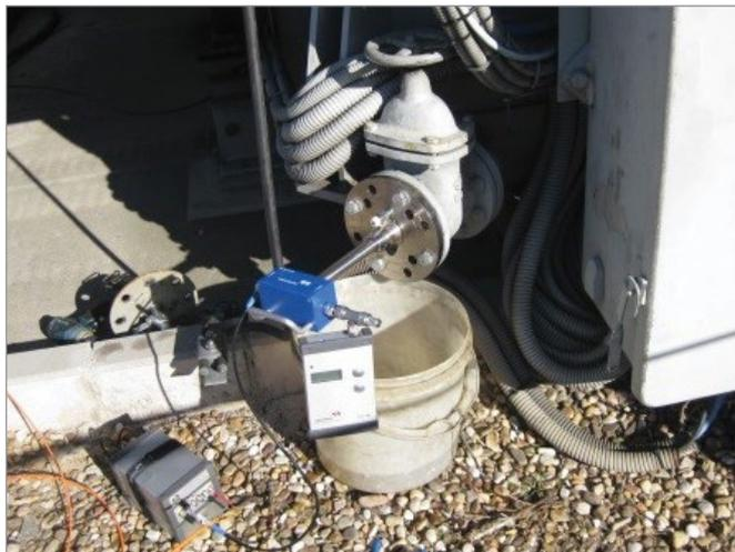
Датчик сливного вентиля для временной установки в трансформатор для измерения ЧР в диапазоне УВЧ
