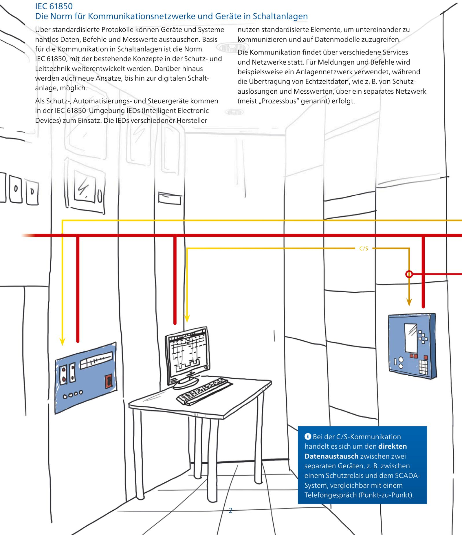
**i** Bei der C/S-Kommunikation handelt es sich um den **direkten Datenaustausch** zwischen zwei separaten Geräten, z. B. zwischen einem Schutzrelais und dem SCADA-System, vergleichbar mit einem Telefongespräch (Punkt-zu-Punkt).
