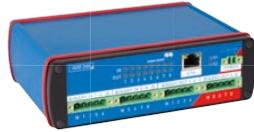
Das kompakte ISIO 200 bietet eine flexible Möglichkeit, zusätzliche lokale Binäreingänge und -ausgänge bereitzustellen. Für die Kommunikation mit IEDs und CMC-Prüfgeräten kommen IEC-61850-GOOSE-Meldungen zum Einsatz, und es können unterschiedliche Datenmodelle aktiviert werden. Über das Web-Interface und einen kompletten IEC-61850-Server bietet das Gerät auch eine direkte Verbindung zur IEC-61850-Welt.
