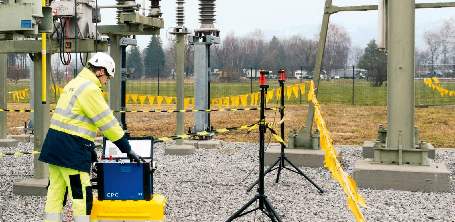
SAA2 im Einsatz während einer Transformatorprüfung.
