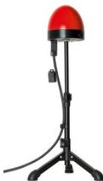
El reloj Grandmaster OTMC 100p sirve la PTP IEEE 1588 a la red de acuerdo con el perfil de compañía eléctrica definido en IEC 61850-9-3. Cuando es necesario, el dispositivo TICRO 100 convierte la PTP de nuevo a varios protocolos de tiempo heredados. El CMGPS 588 está disponible específicamente para los equipos de prueba CMC.
