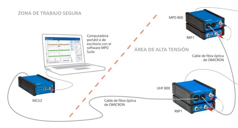
La realización de mediciones de DP en el interior de la cuba del transformador en el rango de UHF garantiza su solvencia frente al ruido ambiental.
