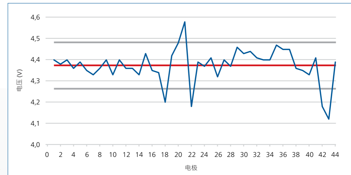
红线表示平均值。并非所有测量值都处在平均值 \pm 2.5\% 的可接受范围内。这表明可能存在匝间故障。
