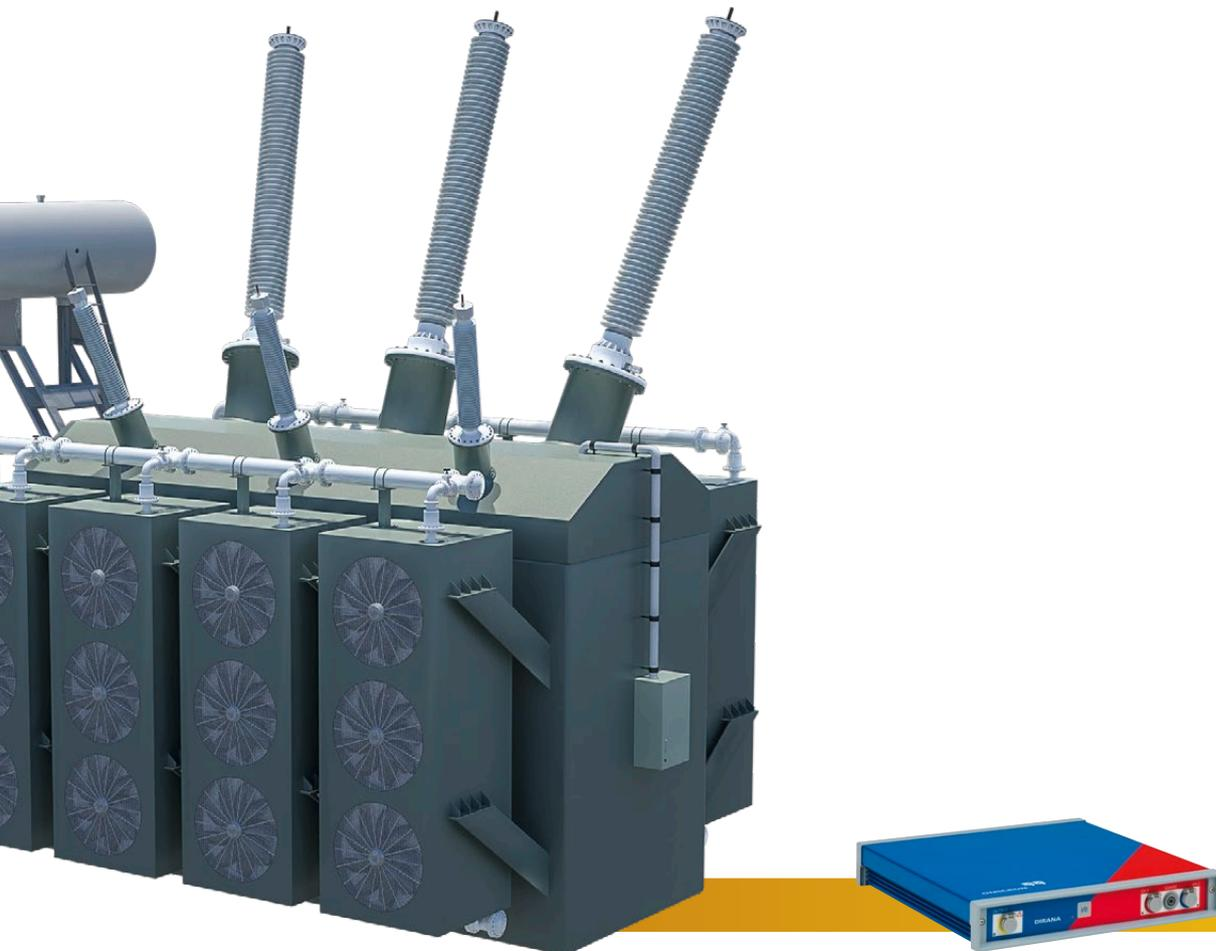
Le DIRANA détermine la teneur en humidité des transformateurs de puissance et de mesure isolés avec du papier huilé et évalue l'état des traversées en analysant la réponse diélectrique.
