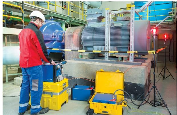
La solution de test 15 kV d'OMICRON pour machines tournantes inclut l'amplificateur haute tension et le module de mesure du facteur de puissance/dissipation CP TD15, la bobine de compensation CP CR600 et l'équipement de test multifonction CPC 100.
