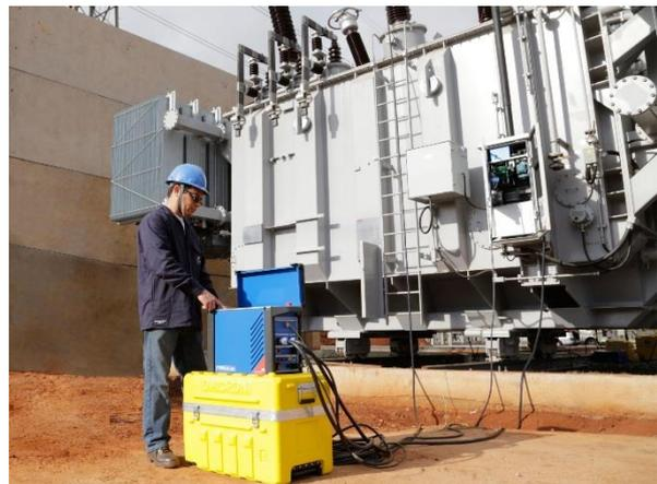
Благодаря трем встроенным источникам тока и простой схеме подключения испытания силовых трансформаторов выполняются быстрее и с минимальными усилиями.
