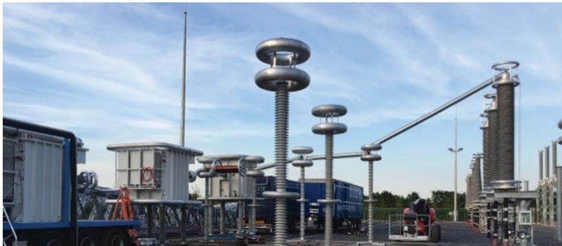
*Figure 10. Montage de test par résonance pour tester le système de câbles*
